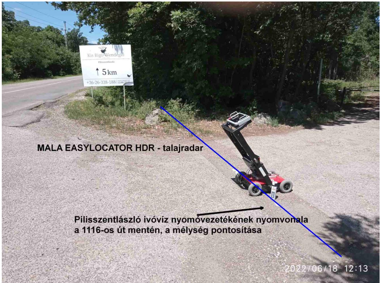
Terepi munkák - Talajradarral végzett közmű felmérés
